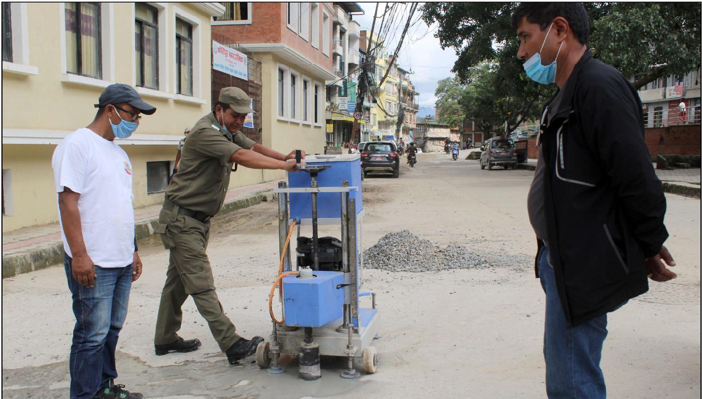
**कडा निरीक्षण :** कीर्तिपुर नगरपालिकाका बाटो ढलानका योजनाहरू ठीक छ/छैन भनी कीर्तिपुर नगरपालिकाको नयाँ भवन अगाडिकै ढलान नै प्वाल पारी निरीक्षण गर्दै कीर्तिपुर नगरपालिकाका कर्मचारीहरू । नगरपालिकाले सबै ढलान गरेका बाटाहरूमा यसरी नै प्वाल पारेर निरीक्षण गरिरहेको छ ।
